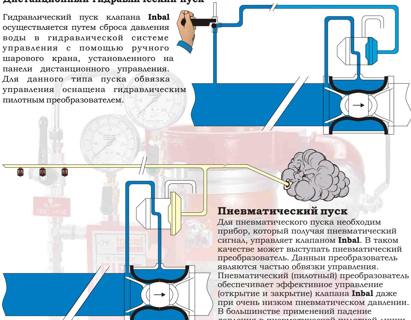
управления приводит к открытию клапана **Inbal**, однако имеются применения, где для открытия клапана **Inbal** необходимо наоборот создать давление в пилотной линии.
