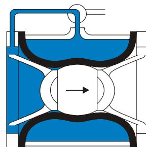
Клапан **Inbal** открывается, когда вода из камеры управления сбрасывается в атмосферу и давление в ней падает. Резиновый рукав освобождает пластиковую сердцевину и прижимается к внутренней стенке корпуса, открывая полный проход воде. Поток воды проходит через клапан с незначительной потерей давления.
