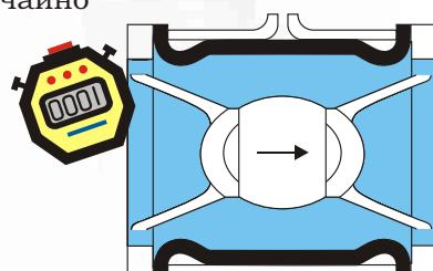
Скорость закрытия / открытия клапана **Inbal** может быть очень низкой, если сильно ограничить поток воды подаваемый в камеру управления при закрытии и сбрасываемый из камеры управления при открытии. Прибор регулирования скорости закрытия / открытия может устанавливаться при необходимости практически во всех типах клапанов **Inbal**.
